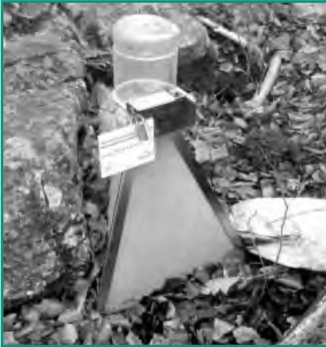
Emergenz-Trichterfalle, zur laufenden Erfassung von Bioindikatoren (Wasserinsekten), Technik: Roland Mayr. Foto: Erich Weigand
