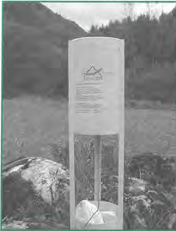
Meteorologisches Freilandgerät: Niederschlagsmesser. Foto: Archiv Nationalpark Kalkalpen
