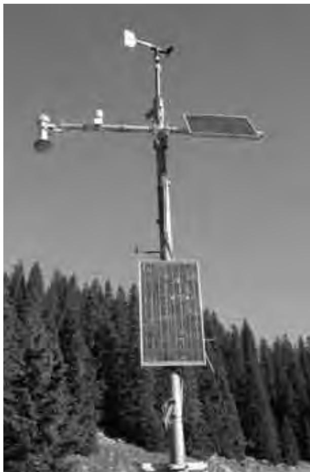
Foto: Die vollautomatische Messstation auf der Feichtaualm in 1400 m Seehöhe mit online-Übertragung von meteorologischen Daten direkt ins www-Netz. (Foto: Archiv NP Kalkalpen/Weigand)
