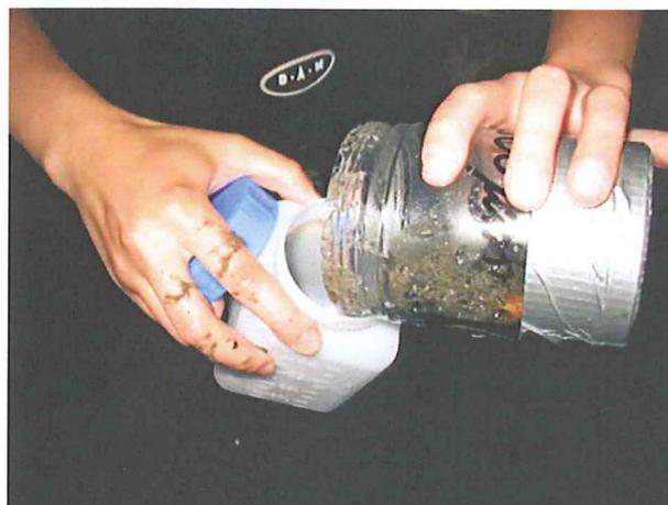
Abbildung 8. Voller Netzbecher (links) und Überführung des Becherinhalts in die etikettierte Weithalsflasche (rechts).
