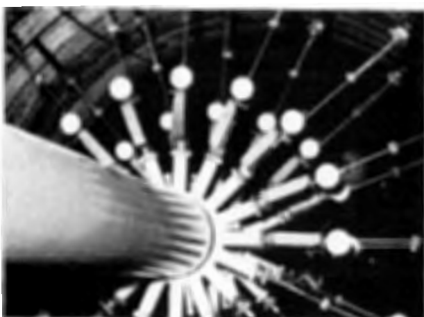
Abb. 7. Radialpresse zur Prüfung des Verformungsverhaltens und Bestimmung des Verformungsmoduls
