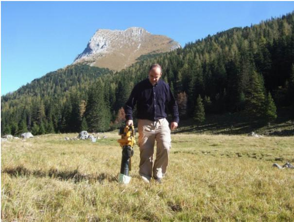
Abbildung 10: Probenahme mit dem modifizierten Laubsauger („G-Vac“).
