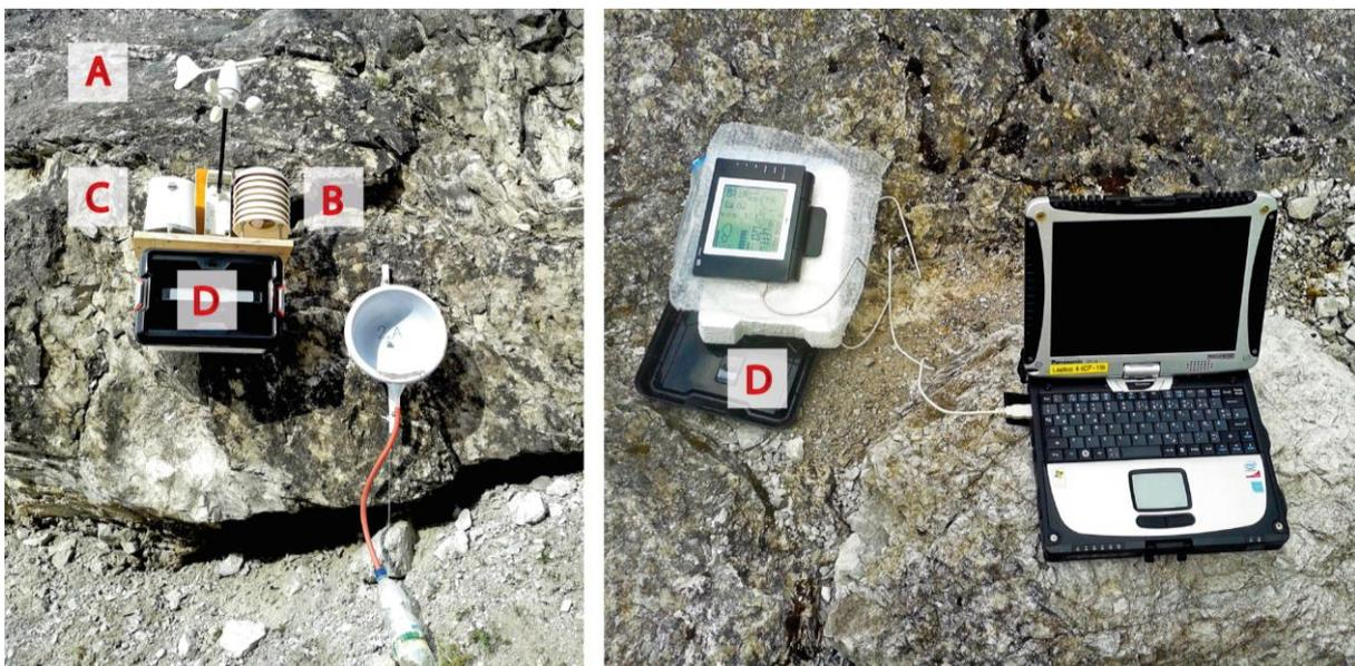
Abbildung 14: Darstellungen des Settings der Nexus Funkwetterstationen: A: Windsensor, B: Thermo-/Hygrosensor, C: Niederschlagssensor, D: Speichereinheit mit Witterungsschutz. Li südexponierte Nexus-Station auf 800 m Höhe. Re. Auslesen der Speichereinheit. Quelle: Eigener Entwurf
