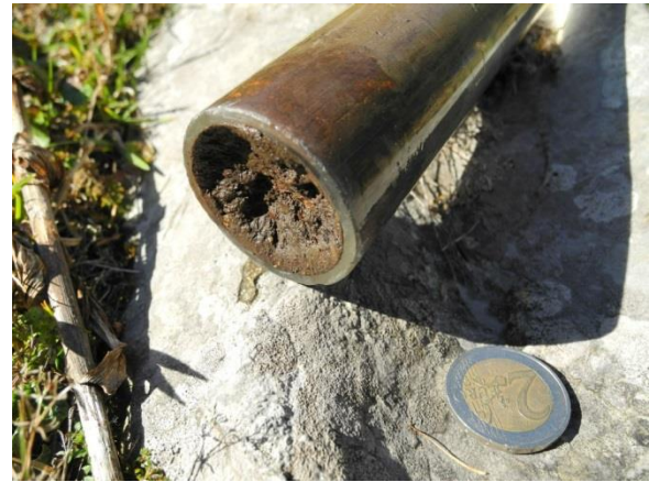
markante 2-Schichtbildung, in der Tiefe sehr kompakt
