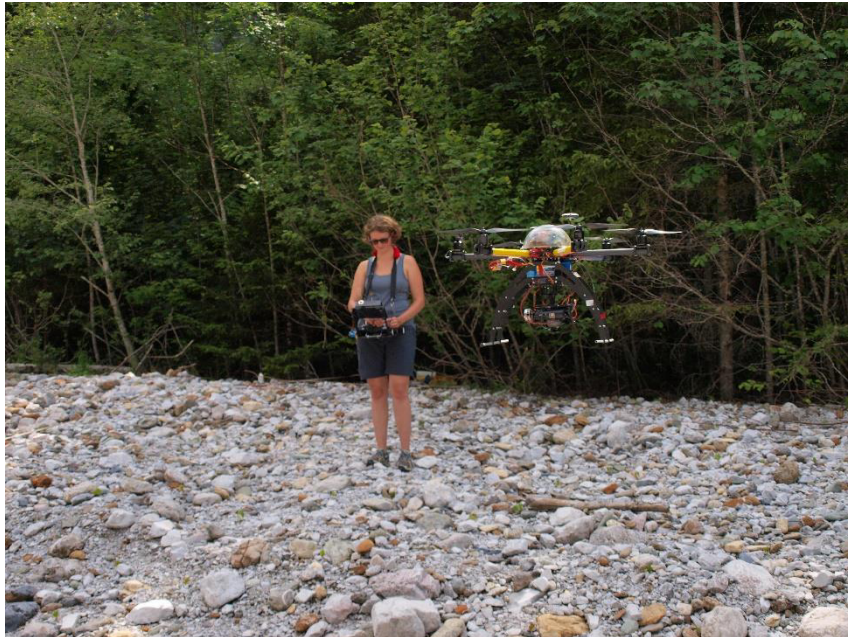
Abbildung 11: E.C.O. pteryx kurz nach dem Start Mit dem Multikopter können vorgeplante Flugrouten abgeflogen und Bilder in Sekundenabständen gemacht werden, sodass man nach dem Entzerren der Bilder ein Orthofoto der Region in hoher Auflösung erhält.
