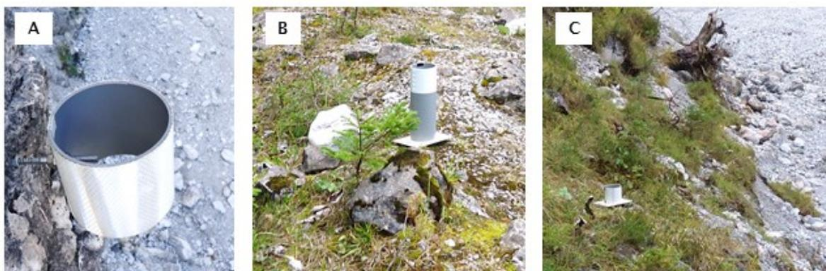
Abbildung 11: Eingesetzte TLS Targets im LGG (A) Fixe Targets Sedyn-X Projekt, (B) Mobile Target groß, (C) Mobile Targets klein. (Eigene Darstellung)
