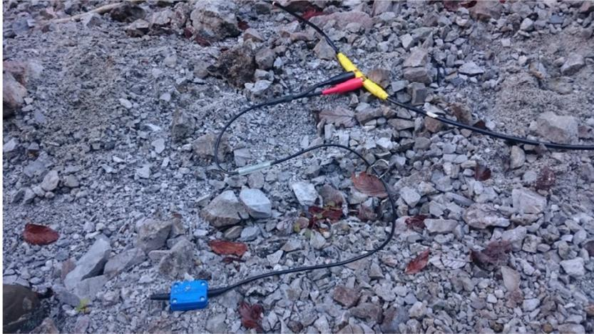
Abb. 27: Anschluss der Geophone am Kabel (Quelle: Eigene Aufnahme, 2015)
