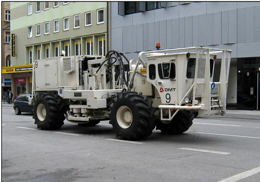
Abb. 18: Spezialfahrzeug zur Signalerzeugung bei der Vibro-Seismik (Quelle: WIKIMEDIA, 2016)
