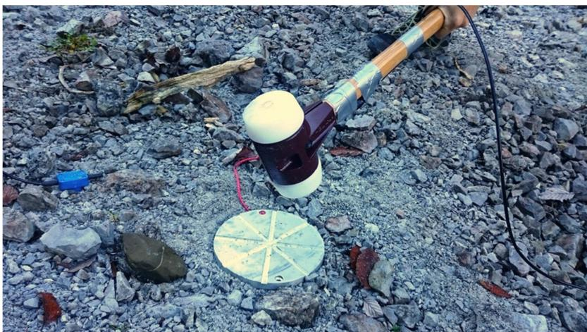
Abb. 28: Metallplatte und Vorschlaghammer mit daran befestigtem Erschütterungssensor (Quelle: Eigene Aufnahme, 2015)
