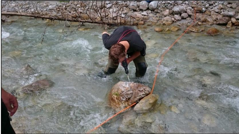
Abb. 22: Einbohren der Elektroden am Felsen (Quelle: Eigene Aufnahme, 2015)
