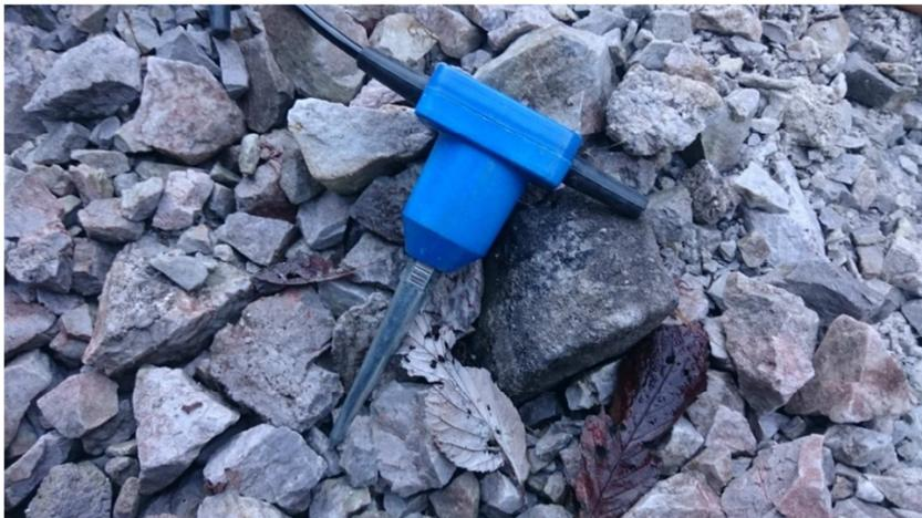
Abb. 26: Die verwendeten Geophone bei der Geoseismik (Quelle: Eigene Aufnahme, 2015)
