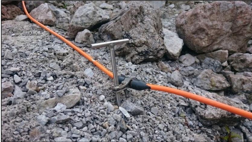
Abb. 20: Elektroden der Geoelektrik (Quelle: Eigene Aufnahme, 2015)
