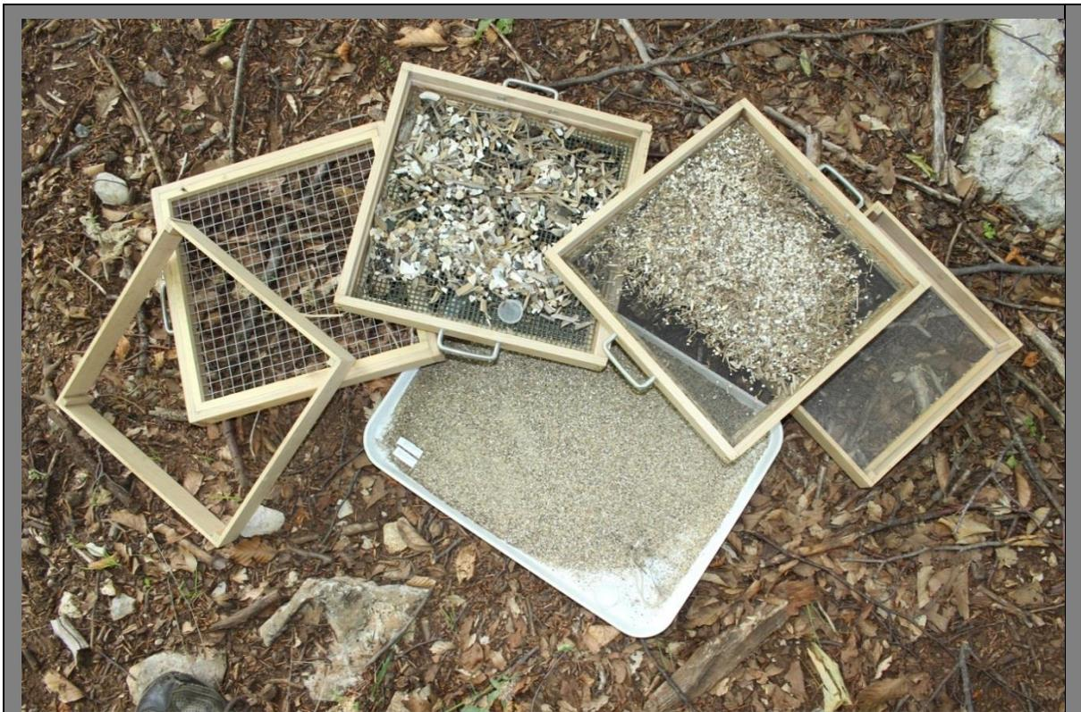
Abbildung 11: Bodensieb zur Auftrennung der Bodenproben in Fraktionen unterschiedlicher Körnungsgrößen. [Foto: J. Volkmer]
