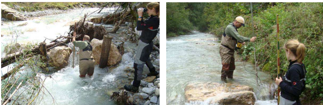
Abb. 35: Kartierung der Schwellen im Johnsbach mittels Messung der Breite, Absturzhöhe und Fließgeschwindigkeiten.
