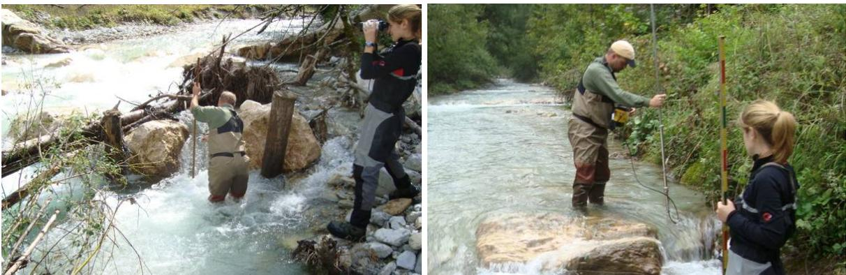
Abb. 17: Kartierung der Schwellen im Johnsbach mittels Messung der Breite, Absturzhöhe und Fließgeschwindigkeiten.
