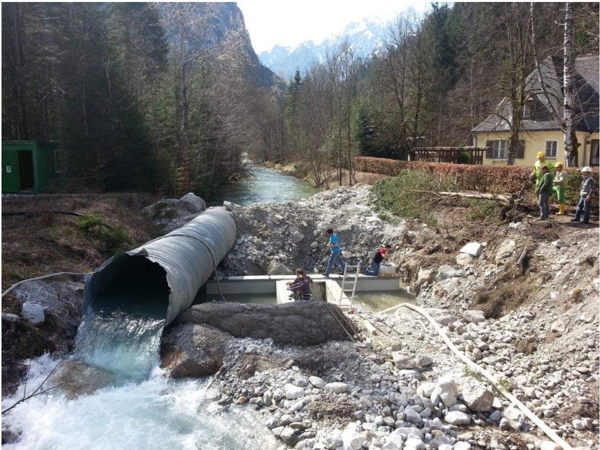
Abbildung 6: Geschiebefalle und Geophon im Johnsbach
