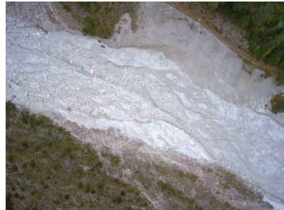
Figure A.3.6: Aus der Vogelperspektive (Drohnenaufnahme aus rund 100m Höhe) lassen sich deutlich die fluvialen Formen im Gerinnebett erkennen (Foto: KFU Graz, Institut f. Geo. und Raum.).
