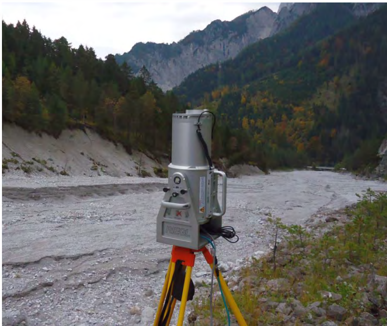
Figure A.3.10: Der Terrestrische Laserscanner bei der Arbeit. Der Scanner nimmt dabei pro Sekunde bis zu 11.000 Punkte auf und operiert im Infrarotbereich; der Laserstrahl ist somit für das menschliche Auge nicht sichtbar (Foto: S. Schöttl).
