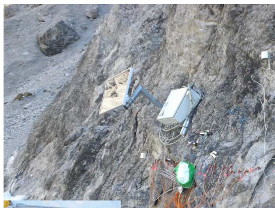
Figure A.2.5: „Verhau am Fels“: Sensoren für Temperatur- und Geoelektrikmessung im Gsenggraben (Foto: M. Rode).
