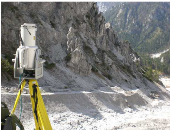
Figure A.1.2: Im Gsengraben werden die seitlichen Sedimenthalden mehrfach im Jahr mittels Terrestrischem Laserscanning (TLS) vermessen.
