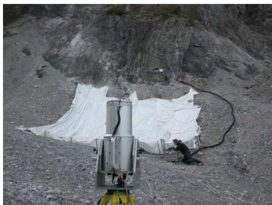
Figure A.2.4: Gesteinsfeuchte- und Steinschlag-Messstation im Gsenggraben mit Laserscanner und Steinschlagnetz (Foto: M. Rode).
