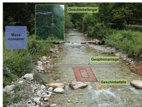
Figure A.2.7: Schematischer Aufbau der Geschiebemesstation Bachbrücke (Foto und Bearbeitung: R. Rindler).
