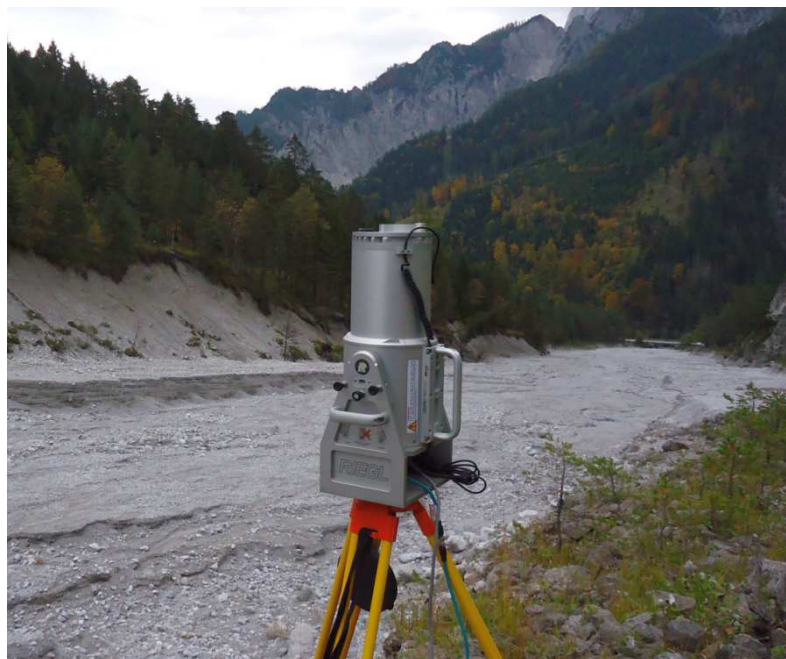
Figure A.3.10: Der Terrestrische Laserscanner bei der Arbeit. Der Scanner nimmt dabei pro Sekunde bis zu 11.000 Punkte auf und operiert im Infrarotbereich; der Laserstrahl ist somit für das menschliche Auge nicht sichtbar (Foto: S. Schöttl).
