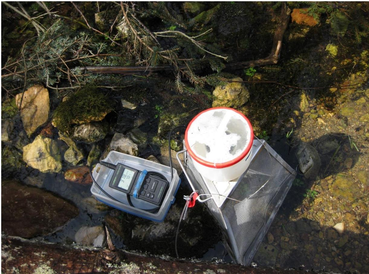
Abbildung 1: Messung der Wassertemperatur und der elektrischen Leitfähigkeit mittels Konduktometers bei der Emergenzfalle in der Etbachquelle – Foto: C. Remschak 03.04.2018
