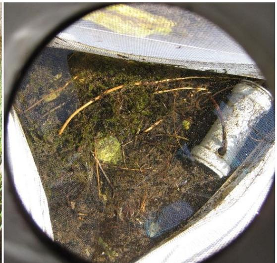
Abb. 4c-d: Die zweite Emergenzfalle ETZ-EM2 im mit Gräsern bewachsenen Bereich und die Innenansicht der Falle mit der Schutzhülle des Datenloggers für die Wassertemperatur.
