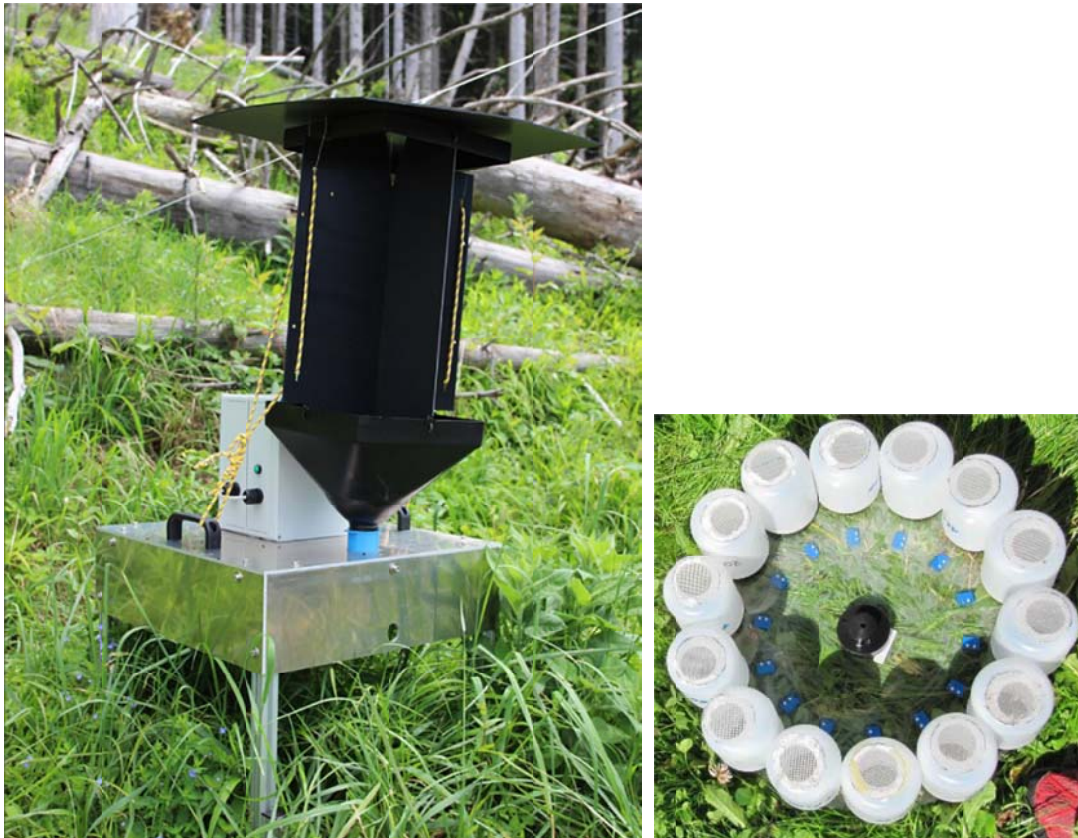
Abb. 3: Fallenautomat (links) und zeitgesteuerter Drehteller mit 14 Auffangbehältern (rechts, Ansicht von unten)
