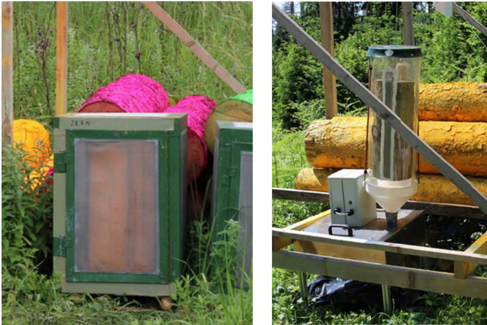
Abb. 4: Kontrollstämme in Käfigen (links) und Stammeklektor mit Fallenautomat (rechts) zur Ermittlung der ausschlüpfenden Buchdrucker aus eingefärbten Stämmen
