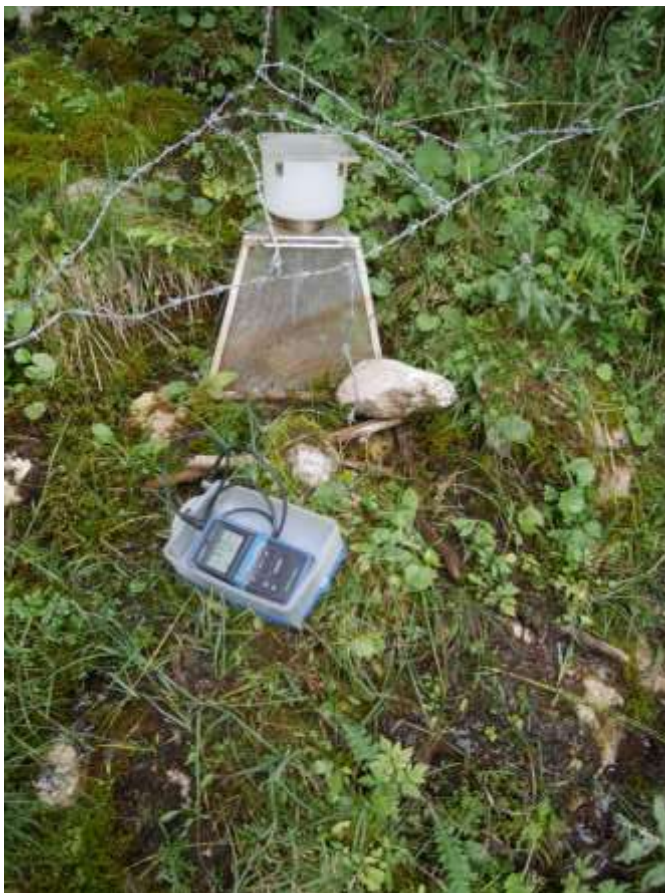
Abbildung 1: Emergenzfalle im Dachlerwaldgraben mit Stacheldrahthäubchen als „Viehschutz“. Davor das Leitfähigkeitsmessgerät, mit dem Wassertemperatur sowie Leitfähigkeit des Wassers bei jeder Leerung der Falle gemessen wurde. – Foto: C. Remschak
