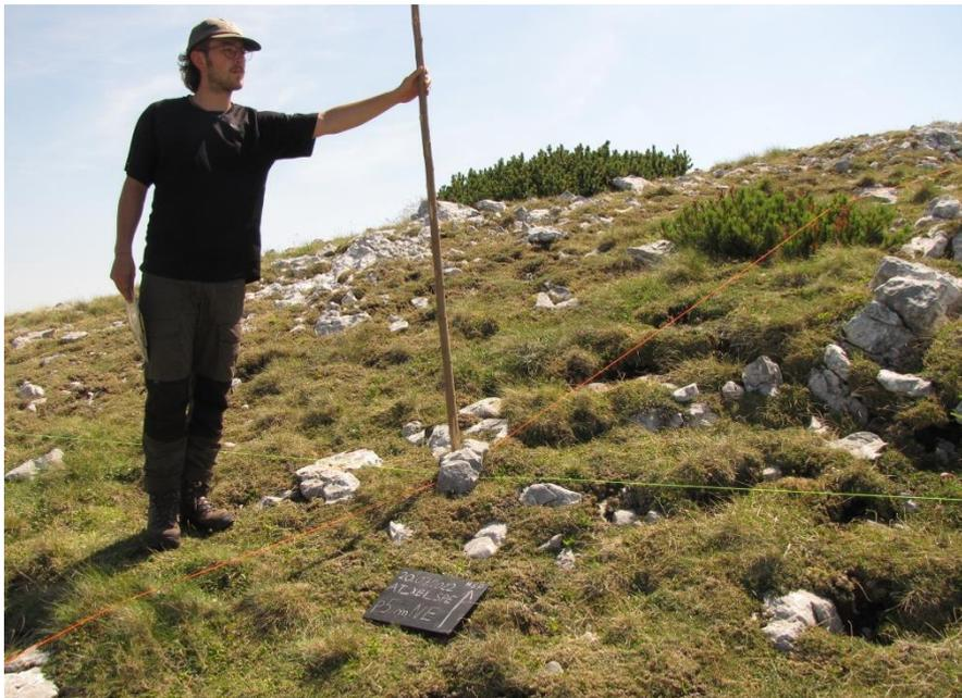
**Abbildung 8: Fotodokumentation eines Punktes mittels Schreiftafel und Stock. In diesem Fall der Punkt SPE\_5m-NE (Schnittpunkt der Nordost-Grenzlinie und der 5 Meter Höhenlinie am Speikgupf) mit Kartierer N. Türk; Foto: M. Suen**
