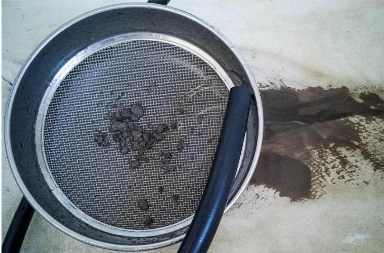
**Abb. 13:** Ausschlämmen einer Probe aus dem Sulzkarsee (Nationalpark Gesäuse, Steiermark, Österreich) im 1000µm Sieb, darunter befinden sich die kleineren Siebe 500µm, 250µm und 125µm. Sedimentpartikel, Pollen und organische Reste kleiner als 125µm werden in den Abfluss gespült (Foto Moritz V. Ladurner 03/2022).
