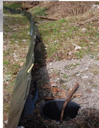
Abbildung 12: Insgesamt 15 Kübel wurden entlang des Zauns eingegraben. – Das Stöckchen darin soll verhindern, dass Spitzmäuse Opfer der Kübel werden.
