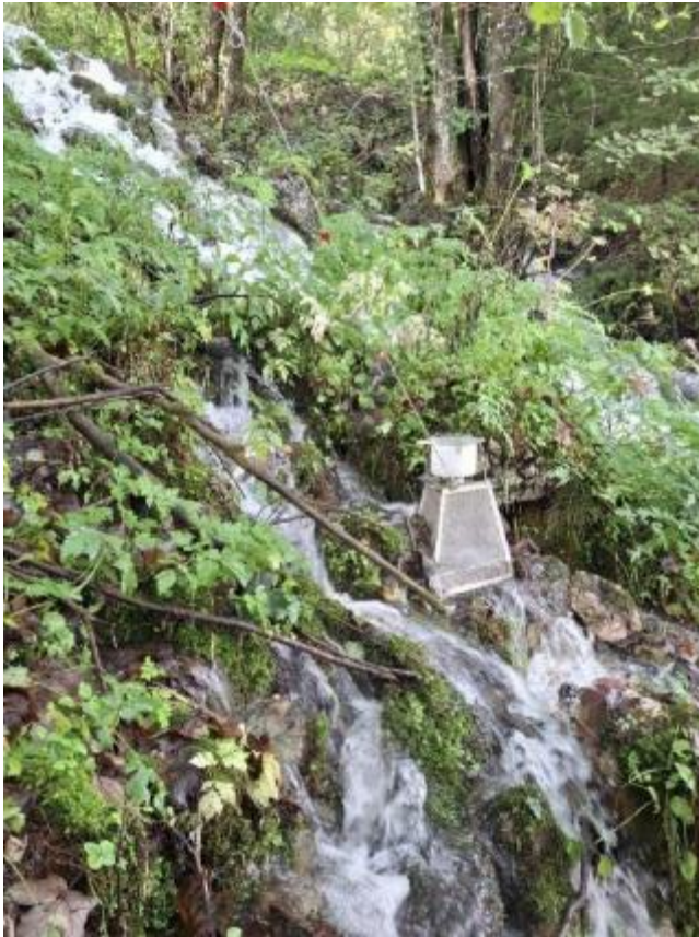
Abbildung 17: Die Emergenzfalle in der Zwanzenbichlquelle war bei starker Schüttung gut von Wasser durchflossen. Zur Sicherheit wurde sie mittels Drahtseil an einem Baum am Uferrand festgehängt. – Foto: C. Remschak, 17.09.2024
