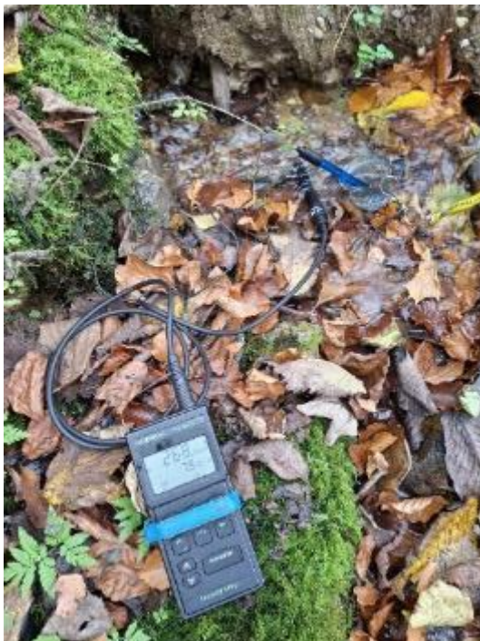
Abbildung 1: Messung der Leitfähigkeit und Wassertemperatur mittels Konduktometer, sowie Messung der pH-Wertes (Kleine blaue Sonde rechts hinten). – Foto: C. Remschak
