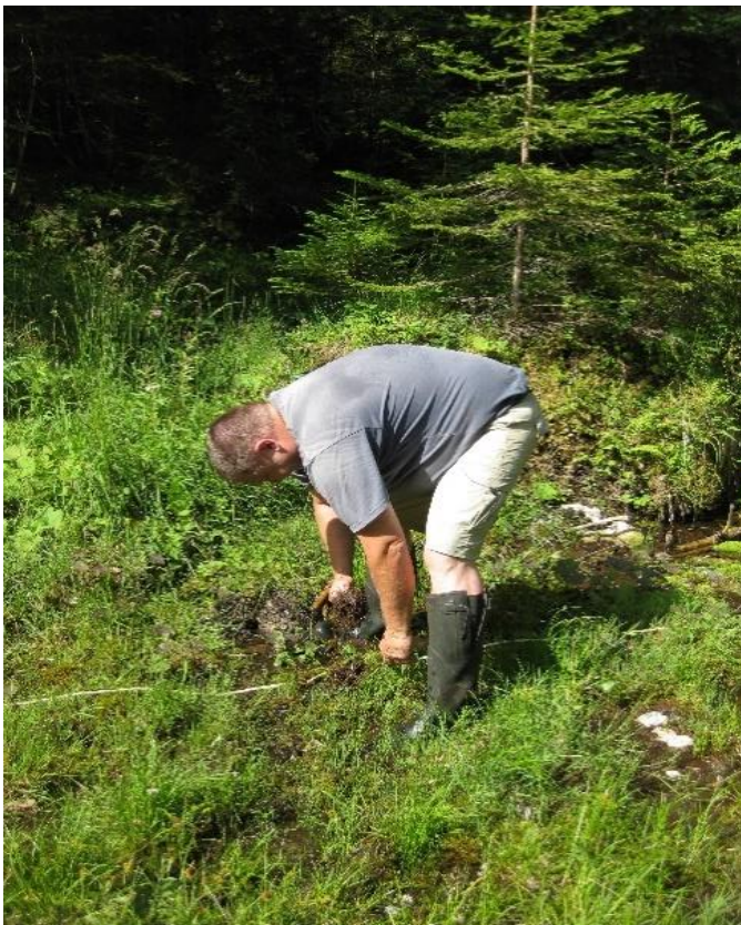
Abbildungen 2 und 3: Der Quertransekt verläuft von Emergenzfalle 3 bis 6. Entlang dieser Linie wurde im Abstand von 1 Meter je eine Bodenprobe genommen, damit die Feuchtigkeit bestimmt werden konnte.
