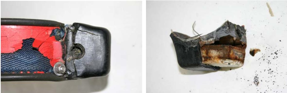
Abbildung 4: Links: Beschädigungen des Halsbandes 1517 durch äußere Gewalteinwirkung, rechts: durch eingedrungene Feuchtigkeit korrodiertes GPS-GSM Modul (Fotos: Vectronic Aerospace)
