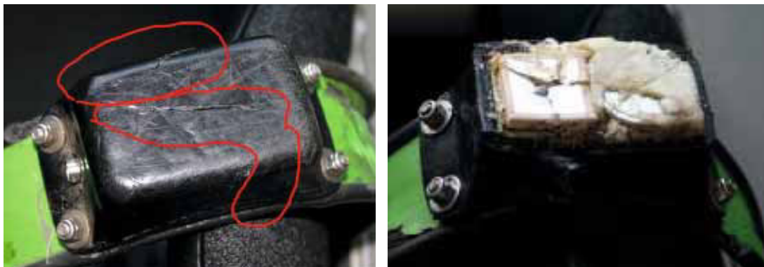
Abbildung 4: Beschädigungen des Halsbandes von Job (1521) durch äußere Gewalteinwirkung (Fotos: Vectronic Aerospace)
