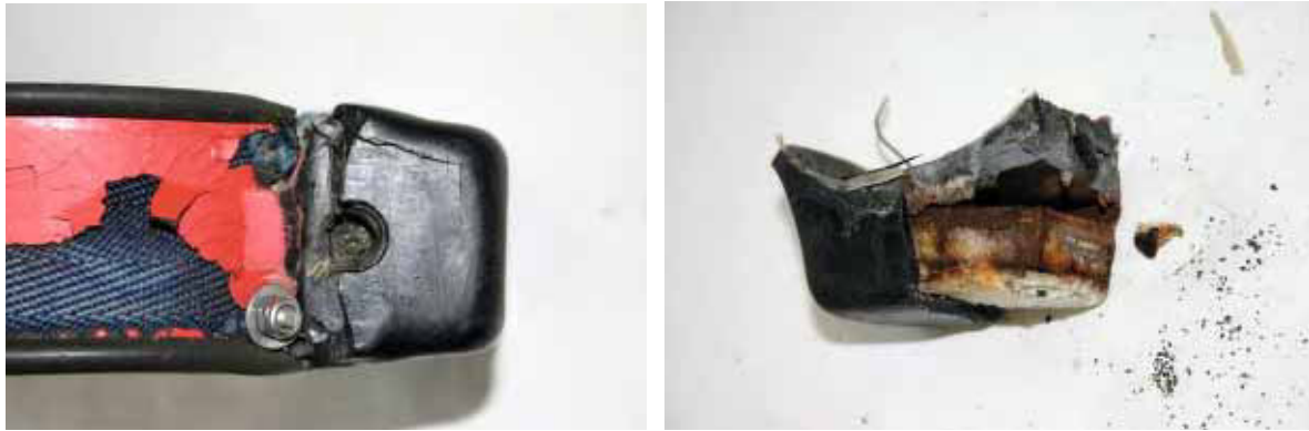
Abbildung 13: Links: Beschädigungen des Halsbandes von Hansl (1517) durch äußere Gewalteinwirkung, rechts: durch eingedrungene Feuchtigkeit korrodiertes GPS-GSM Modul (Fotos: Vectronic Aerospace)
