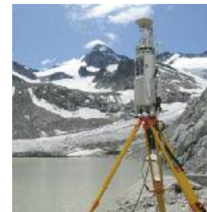
Die Entwicklung des vor einigen Jahren neu entstandenen Gletscherrückens im Obersulzbachtal wird mit Hilfe eines Laserscanners jährlich vermessen.
