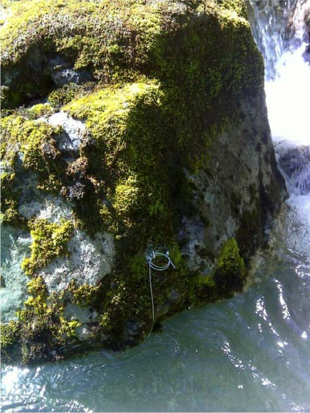
Abb. 29: In allen Bächen wurde an geeigneten Stellen Temperatur-Data-Logger eingebaut. Die Mess-Sonden werden durch ein Kunststoffrohr mit Wasseröffnungen geschützt und mit 3 mm dicken Stahlseilen und Metallösen gesichert. Die aufgezeichneten Daten werden bei jeder Probenahme ausgelesen.
