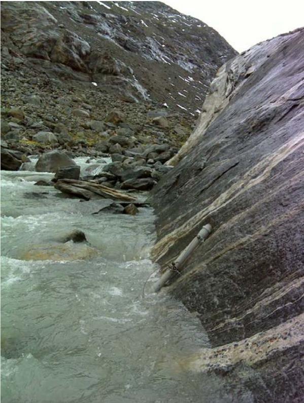
Abb. 30: In allen Gletscherbächen wurden an geeigneten Stellen Pegelmess-Stellen eingerichtet. Die Mess-Sonden werden durch ein doppelwandiges Kunststoffrohr mit Wasseröffnungen geschützt und mit 3mm dicken Stahlseilen und Metallösen am Fels gesichert. Zusätzlich wurde bei ANL\_SB oben eine Pegelsode angebracht; 2011 folgen noch Pegel in WINK\_SB oben und SALZ\_SB oben. Die aufgezeichneten Daten werden bei jeder Probenahme ausgelesen.
