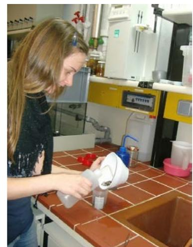
Abb. 47: Fraktionieren der Proben (Filter mit Maschenweite 1000µm, 500µm, 100µm), anschließendes Auftrennen der Subsamples
