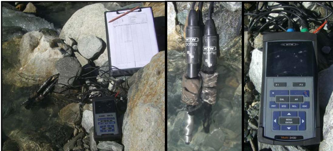
Abb. 43: WTW – MultiLine® 3430 mit pH-Elektrode (SenTix® 940), digitale Leitfähigkeitsmesszelle (TetraCon® 925) und optischer Sauerstoffsensoren (FDO® 925)
