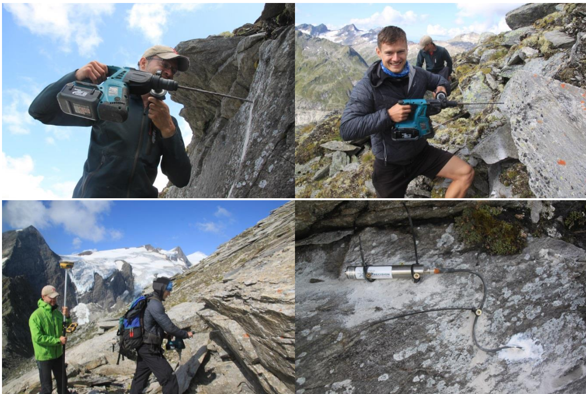
Abbildung 7: Bohraktivitäten an den drei Felslogger-Standorten am Inneren Knorrkogel. Oben links – Standort Flanke-Felslogger-NE; oben rechts – Standort Flanke-Felslogger-W; unten links – Standort Flanke-Felslogger-S; unten rechts – fertig installierter 3-Kanaldatenlogger am Standort Flanke-Felslogger-NE mit Messsensoren in 3, 10 und 40 cm Tiefe. (Fotos: A. Kellerer-Pirklbauer)
