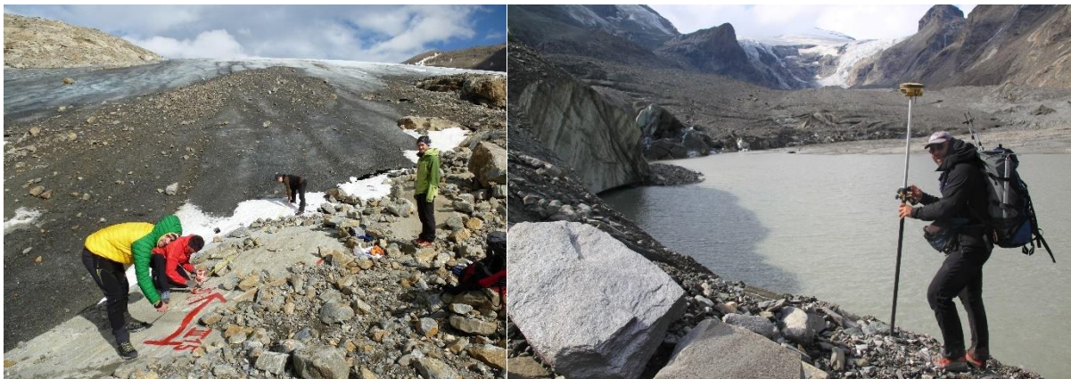
Abbildung 4: Zwei Möglichkeiten der Messung des Gletscherrückzuges: Links: Messung der Längenänderung des Wasserfallwinkelkeeses, eines Nachbargletschers der Pasterze, mittels Maßbandes, wobei die Distanz zwischen einem Fixpunkt und dem Gletscherrand entlang eines genau definierten Azimuts gemessen wird. Rechts: Messung der Längenänderung der Pasterze mittels Differential GPS. Der Rand des Gletschers wird – wo mit geringer Gefahr zugänglich – direkt mit dieser Methode vermessen. (Fotos: G.K. Lieb und A. Kellerer-Pirklbauer)
