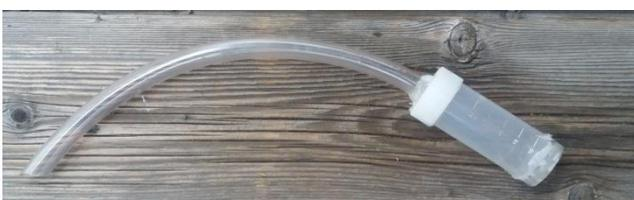
Abbildung 3: Sammelröhrchen mit Saugschlauch
