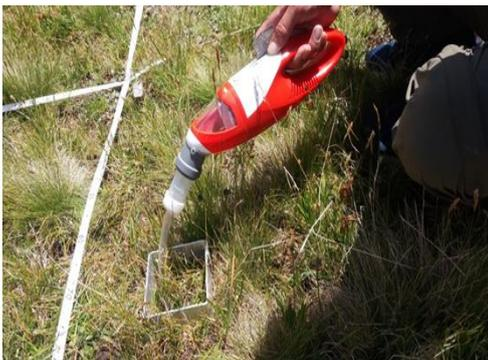
Abbildung 1: Mini-Handstaubsauger mit vorne aufgesetztem Sammelröhrchen und Saugschlauch
