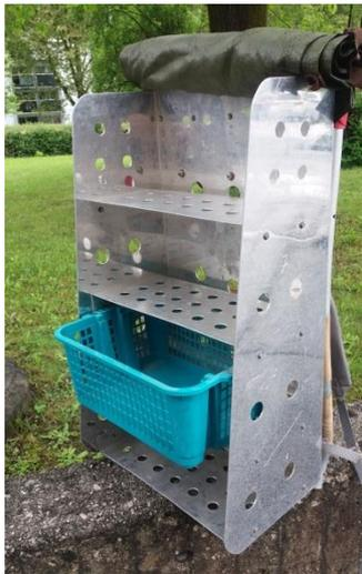
Abbildung 8: Rückentrage zum Transport der Bodenproben in den Körben.
