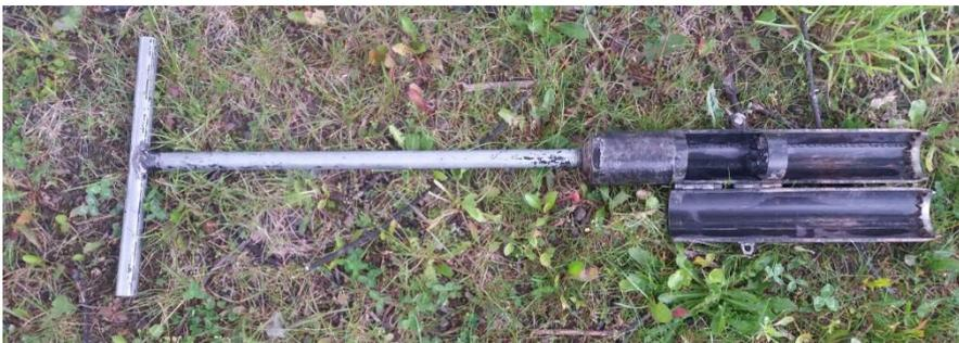
Abbildung 4: Bodenstecher (Splitcorer)
