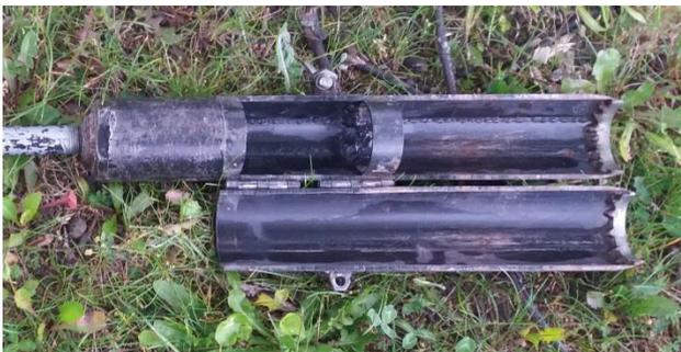
Abbildung 5: Bodenstecher aufgeklappt, eingeschweißter Begrenzungsring zur Aufnahme 3 Probenröhrchen
