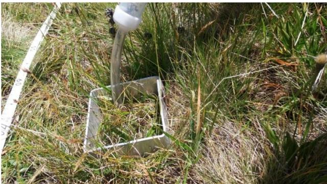
Abbildung 16: Absaugen der durch den Metallrahmen umgrenzten Fläche mit dem Mini-Handstaubsauger
