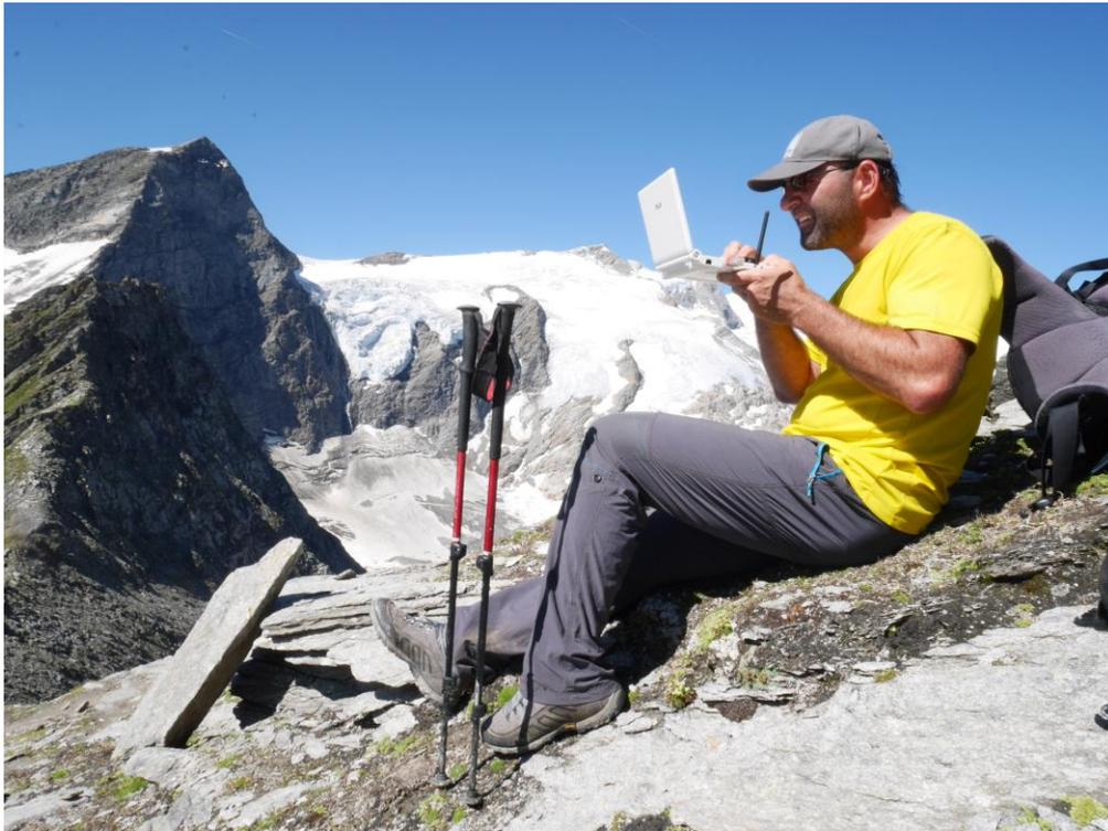
Abbildung 4: Auslesen der Datenlogger via Funkschnittstelle (als schwarzer Stift am Foto erkennbar) wie hier beispielhaft gezeigt am Standort G-1K-SW-2860. Foto: Alexander Dorić.
