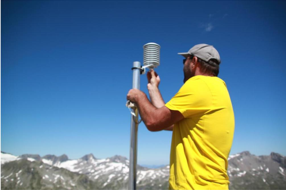
Abbildung 5: Installation eines neuen Temperaturdatenloggers (Code A53A9E) am Standort S-AT-2878. Diese Neuinstallation am 18. 08. 2018 war notwendig, da der von 2018 auf 2019 eingebaute Sensor wahrscheinlich durch Blitzschlag zerstört wurde. Foto: Alexander Dorić.
