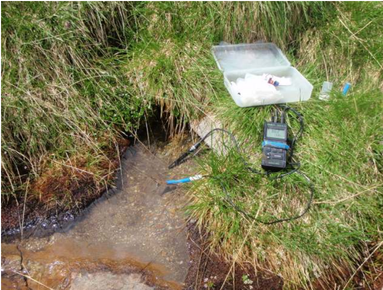
Foto 8: Messeinrichtung (WTW-Gerät) für die Feldparameter: Temperatur, Leitfähigkeit und pH-Wert.
