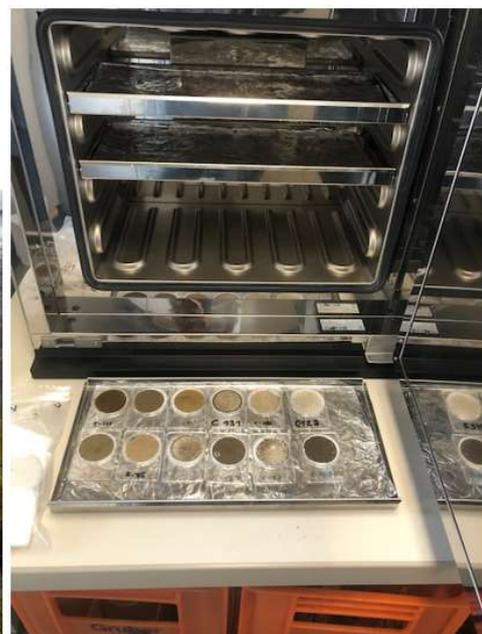
Abbildung 1: Die filtrierte Feststoffe (3 Parallelfiter mit jeweils 2 Liter filtrierte Wasser) wurden im Labor getrocknet, gewogen, verascht (450°C) und wieder gewogen, um die organischen und anorganischen Anteile zu quantifizieren. Foto: V. Semino.
