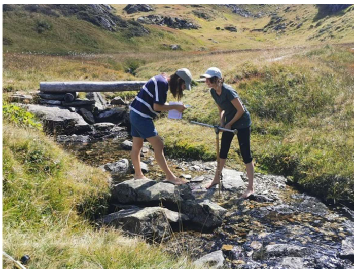
Abbildung 1.: Aufnahmen der Feldarbeiten 2022 (Filtern von Wasser zur Feststellung des organischen und anorganischen Trübstoffgehalts, Besammlung des Aufwuchses, Messung hydrologischer Vergleichsparameter vor Ort mit dem Tauchstab nach Jens)
