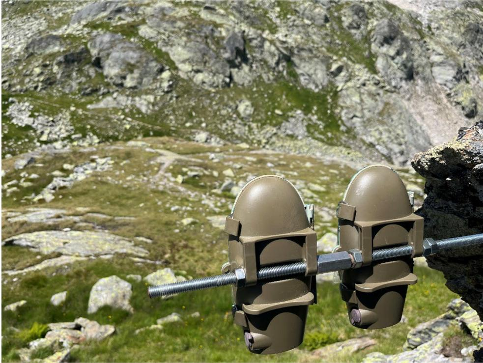
Abbildung 1: Kamera SE10 und die Backup Kamera, welche mittels Muffelmutter auf der Verlängerung der Gewindestange angebracht ist (Foto: Andreas Daim).
