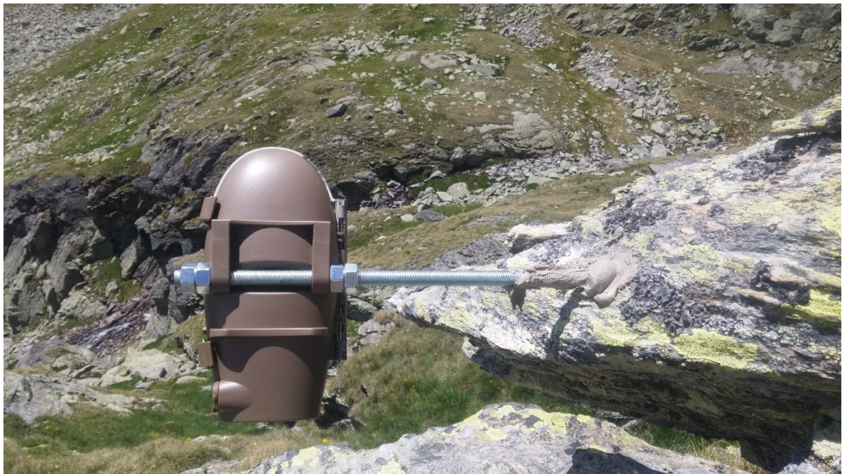
Abbildung 8: Auf einer in den Stein geklebten Gewindestange befestigte Kamera. Ausrichtung und Fixierung der Kamera mit Sechskantmutter und Schraubenschlüssel 19; die festverschraubten innenliegenden Sechskantmutter geben die horizontale Position der Kamera an, mit den außenliegenden Sechskantmutter wird die Kamera in der richtigen Position festgeschraubt; Kamera SE9
