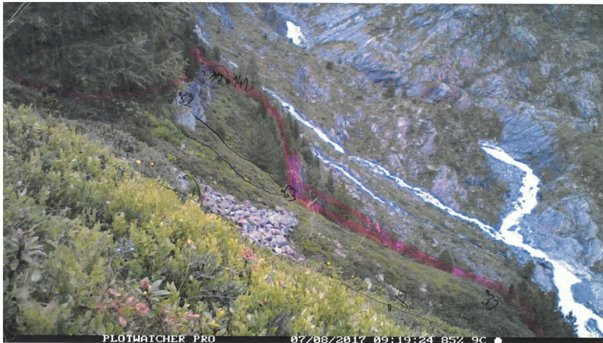
Abbildung 12: IN1, Messung der Entfernungen im Felde mit einem Entfernungsmesser (schwarzer Punkt mit Zahl in m), maximal einsehbarer Bereich = Monitoringsfläche (Grenze rosa Linie).
