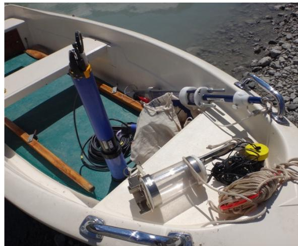
Abbildung 20: Boot der Bergrettung am „See neben Seebachsee“ (Obersulzbachtal). Erkennbar die „Multisonde“ (blau) sowie der Wasserschöpfer für die Gesamtwasserproben.
