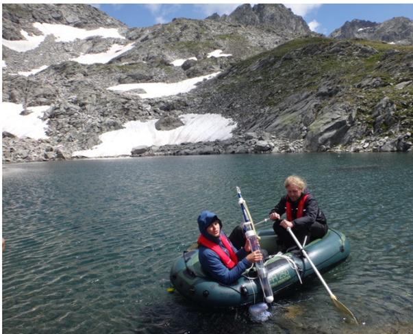
Abbildung 19: Tragbares Schlauchboot während der Beprobung, hier Entnahme eines Sedimentkerns mit dem sog. Sediment Corer („Großes Elend“ Seebachtal).
