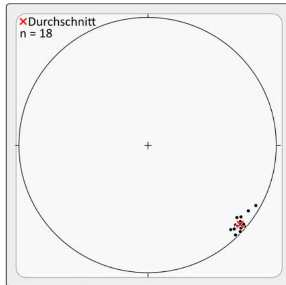
Abbildung 3.32.: Bewegungsvektoren der Messpunkte im Umfeld der Guttalbrücke im Schmidt'schen Netz. Die Mittlere Orientierung kann mit 131/06 angegeben werden.
