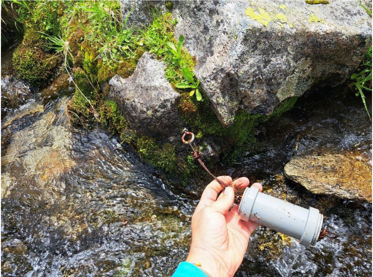
Abbildung 6. Temperaturlogger sind im durchlöchernten Schutzgehäuse (Rohr) verschlossen und am Stein an ausgewählten Stellen fixiert, sodass sie möglichst immer mit Wasser bedeckt sind. CC BY-NC 4.0 Georg H. Niedrist
