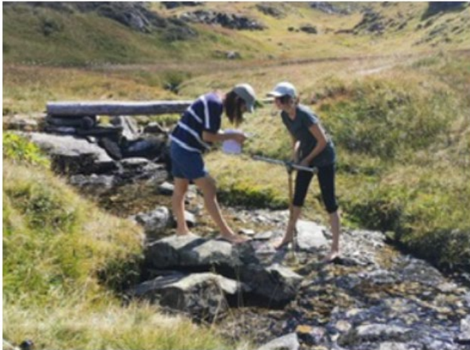
Abbildung 5: Feldarbeiten im Nationalpark Hohe Tauern beim Erheben der Fließgeschwindigkeiten mithilfe des Jensstabes zur anschließenden Abflussberechnung. CC BY 4.0 Vanessa Semino
