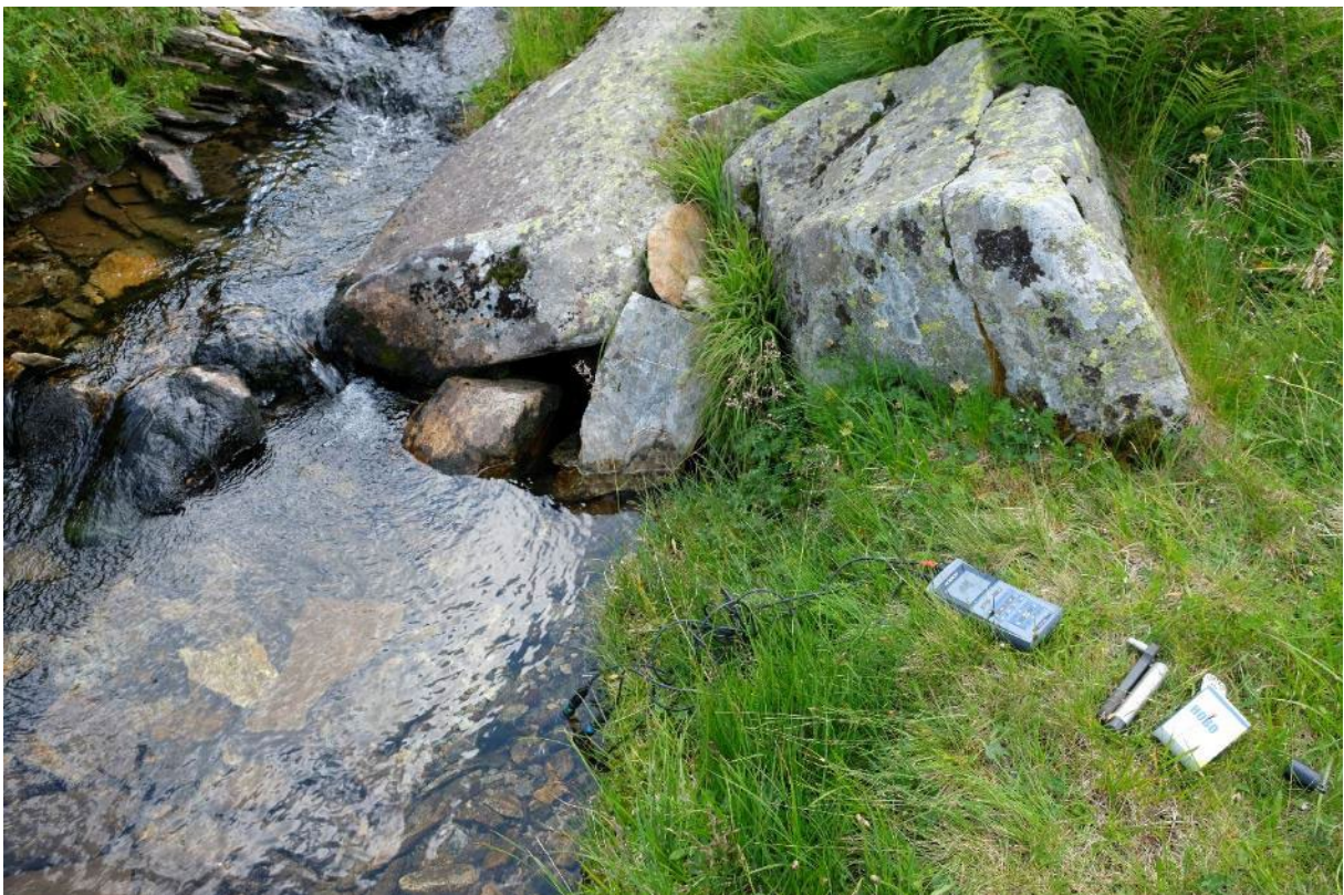
Abbildung 7. Multiparameter-Sonde erhebt pH, Sauerstoff und elektrische Leitfähigkeit des Wassers während der Feldarbeiten. Dahinter befindet sich (hinter Steinen versteckt) der Datenlogger (Pegel und Wassertemperatur) am untersten Punkt (Standort IN). CC BY-NC 4.0 Georg H. Niedrist
