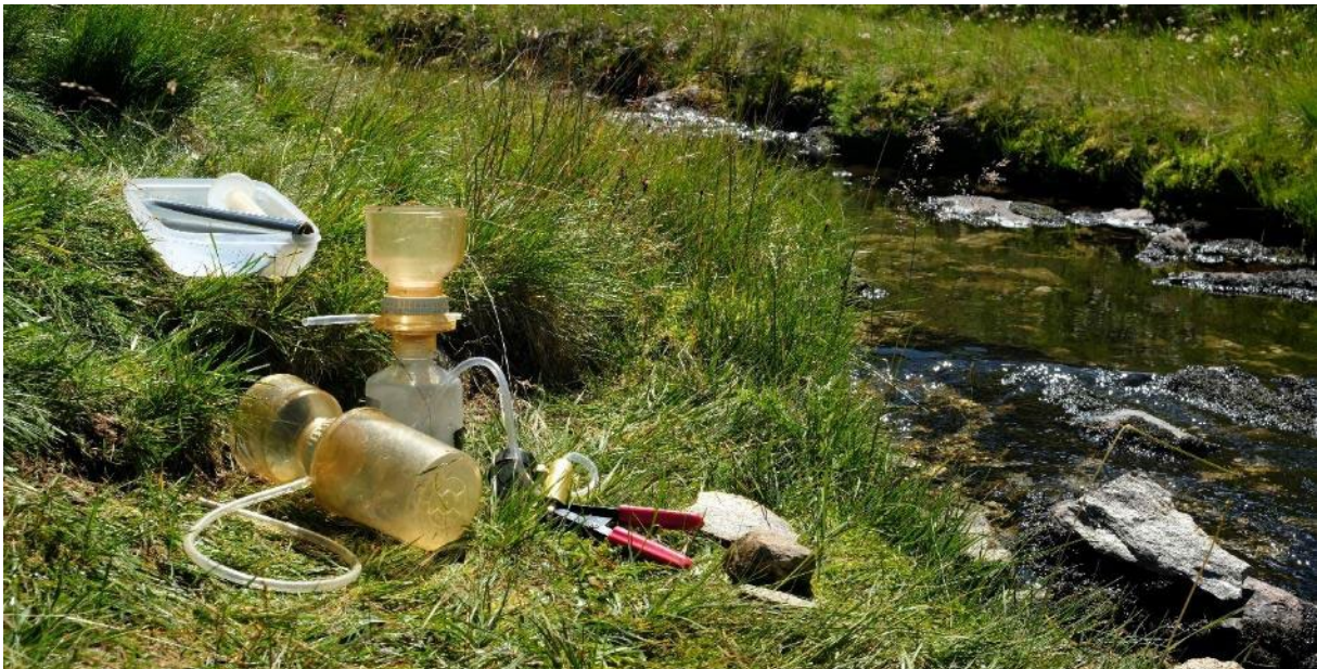
Abbildung 3. Filtrertürme zur Erfassung der Gewässertrübe, der Chlorophyll- a -Konzentration, und des Aufwuchses. CC BY-ND 4.0 Georg H. Niedrist
