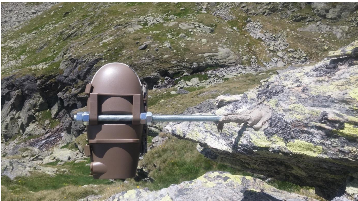
Abbildung 8: Auf einer in den Stein geklebten Gewindestange befestigte Kamera. Ausrichtung und Fixierung der Kamera mit Sechskantmutter und Schraubenschlüssel 19; die festverschraubten innenliegenden Sechskantmutter geben die horizontale Position der Kamera an, mit den außenliegenden Sechskantmutter wird die Kamera in der richtigen Position festgeschraubt; Kamera SE9
