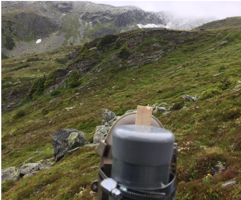
Abbildung 7: Ein Holzkeil wird zur Anpassung der vertikalen Ausrichtung zwischen Rundrohr und Kamera eingeschoben und selbst mit dem Gewebefband am Rundrohr gegen Verrutschen befestigt. Kamera SE4
