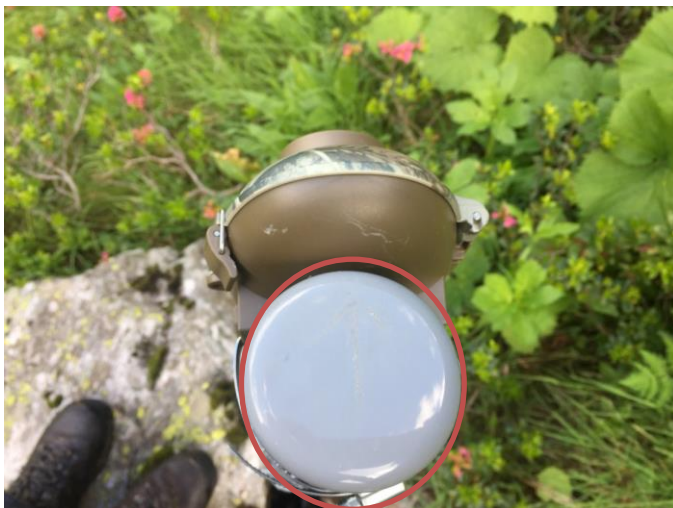
Abbildung 5: Pfeil an der Plastikabdeckung (mit rotem Kreis im Bild markiert; etwas schwer erkenntlich am Bild) zeigt die horizontale Ausrichtung für die Kamerainstallation an
