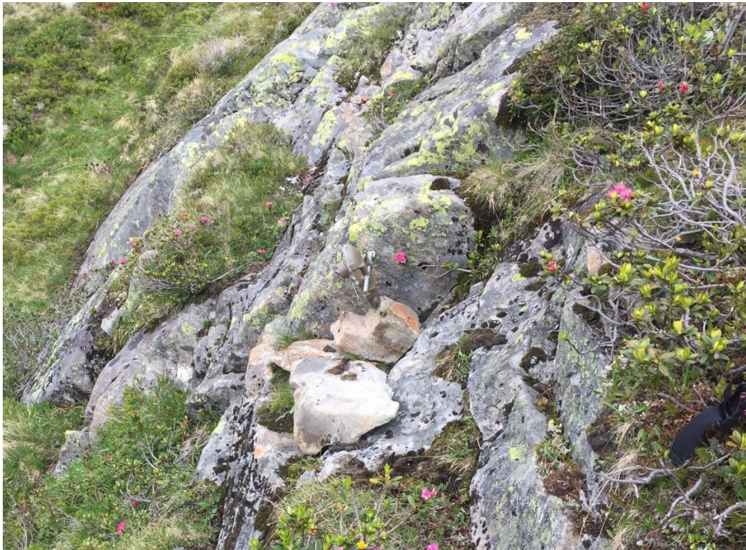
Abbildung 4: Relativ unscheinbare und schwer zu sehende Gewindestange (hier mit Kamera installiert; IN5) im Felsen montiert.
