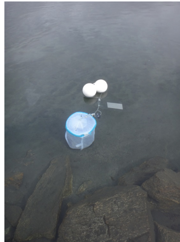
Abbildung 22: Temperaturdatenlogger mit Styroporkugeln für Auftrieb und Sichtbarkeit und mit Steinen in Netzbehälter als Anker.
