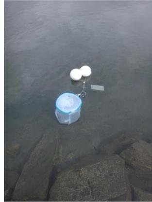
Abbildung 22: Temperaturdatenlogger (tempmate) mit Styroporkugeln für Auftrieb und Sichtbarkeit und mit Steinen in Netzbehältnis als Anker.
