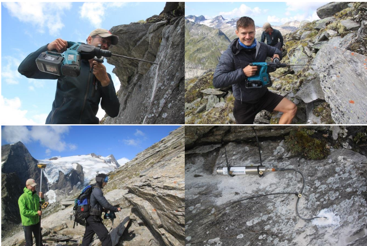
Abbildung 40: Bohraktivitäten an den drei Felslogger-Standorten am Inneren Knorrkogel. Oben links – Standort Flanke-Felslogger-NE; oben rechts – Standort Flanke-Felslogger-W; unten links – Standort Flanke-Felslogger-S; unten rechts – fertig installierter 3-Kanaldatenlogger am Standort Flanke-Felslogger-NE mit Messsensoren in 3, 10 und 40 cm Tiefe. (Fotos: A. Kellerer-Pirklbauer)
