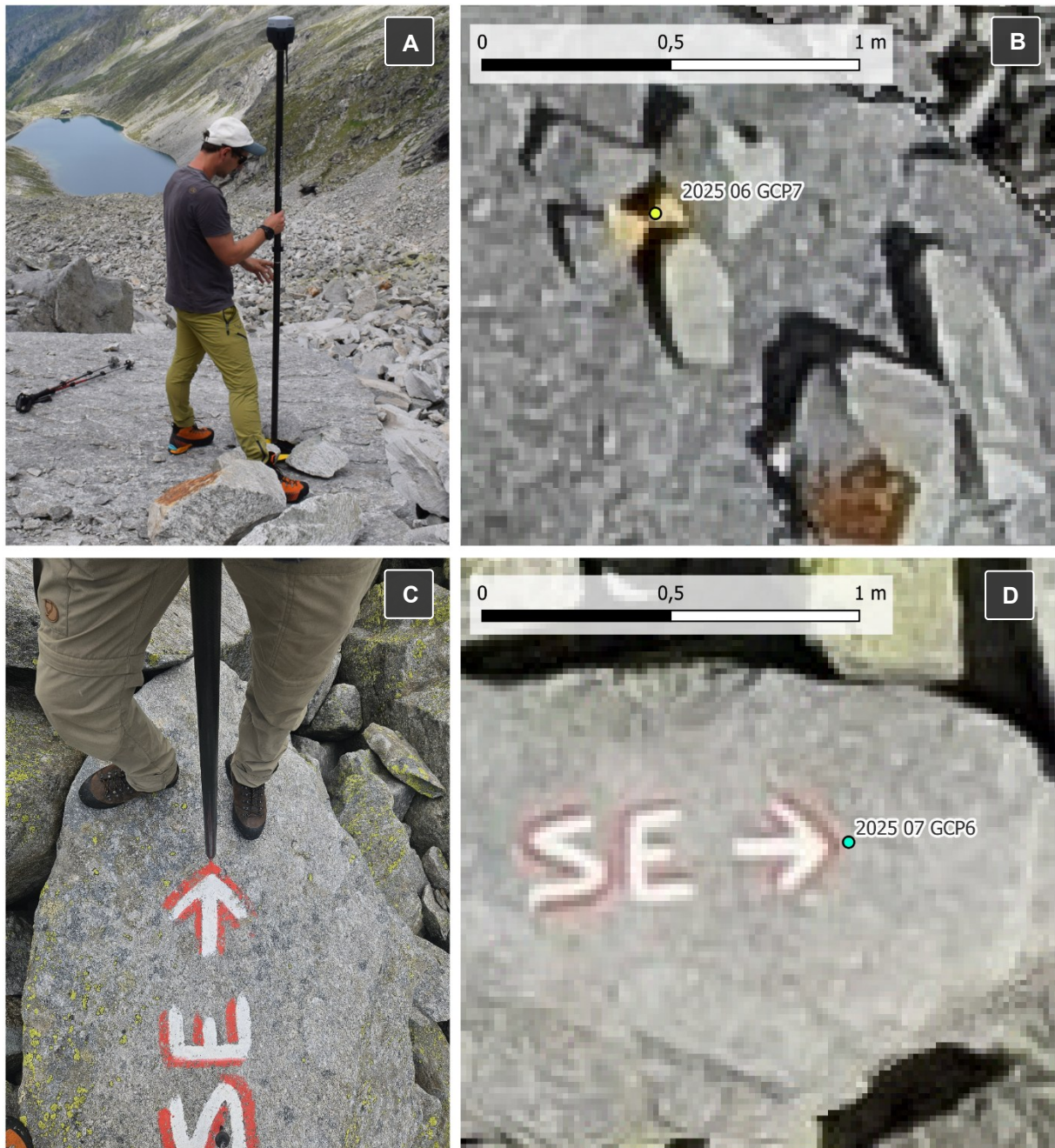
Abbildung 7 Beispiel eines im Gelände ausgelegten Targets (Messkampagne 01, Juni 2025) und dessen Einmessung (A u. B) sowie die angelegten farblich markierten GCPs (Messkampagne 02, Juli 2025) und dessen Identifikation im UAV-Orthofoto (C u. D) (Eigene Darstellung)
