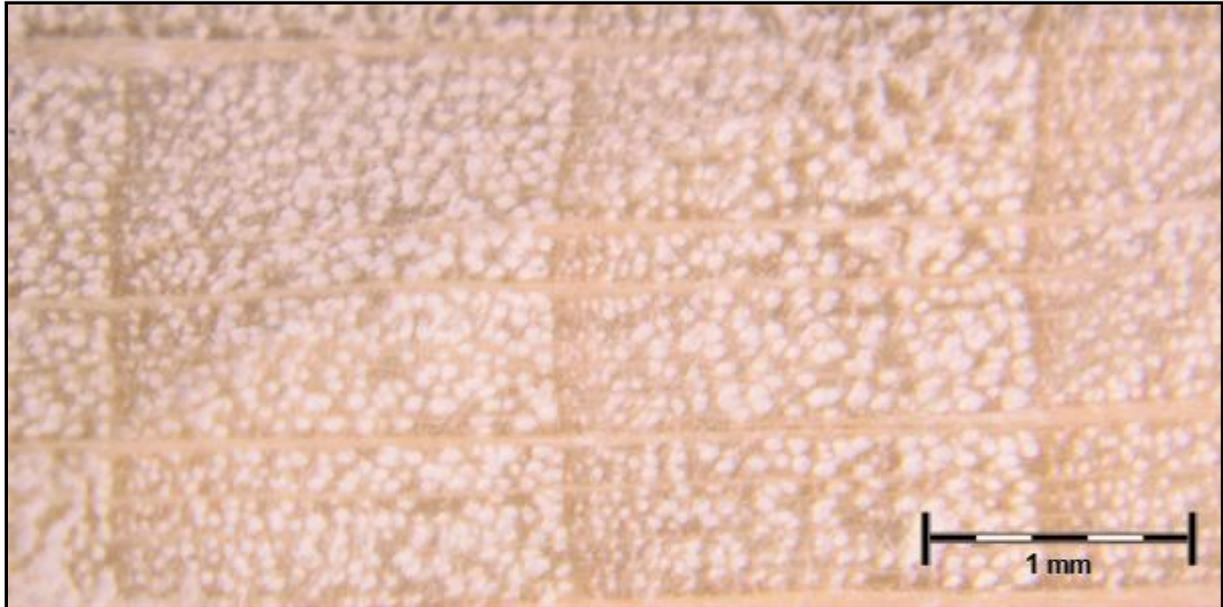
**Abbildung 7:** Querschnittfläche bei Rot-Buche (*Fagus sylvatica*).
