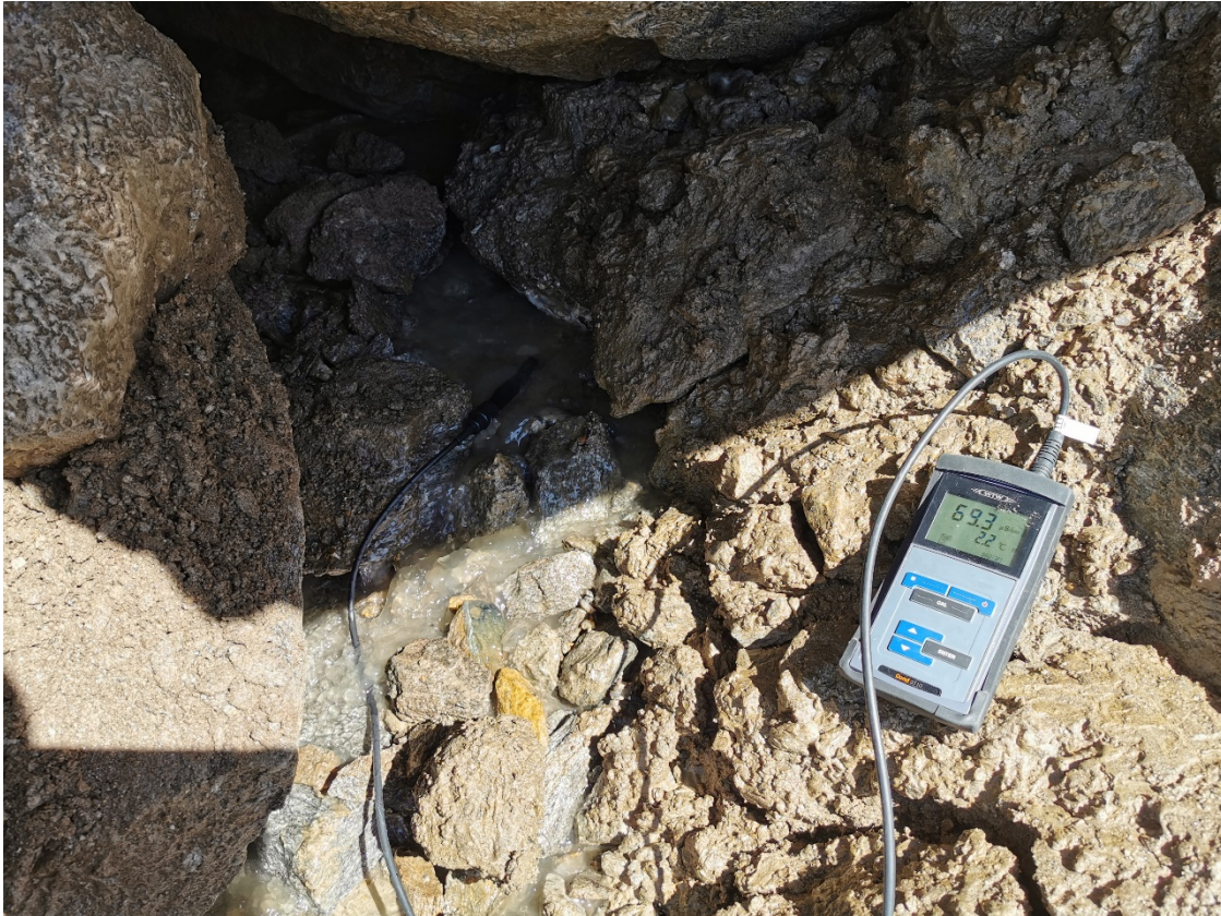
Abbildung 4: Wasserprobenahme zur Analyse der Temperatur, Leitfähigkeit und Isotopen.
