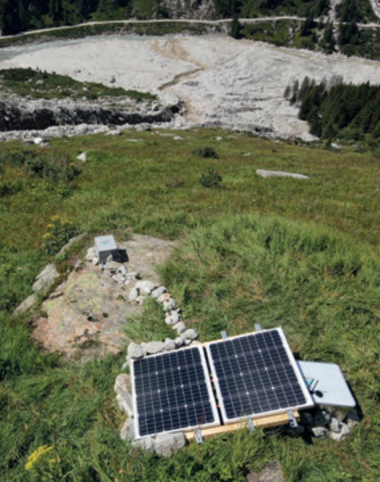
(2) Seismik-Station. Passive Seismik wird verwendet zur Detektion von Mur- und Steinschlagereignissen. © R. Delleske
