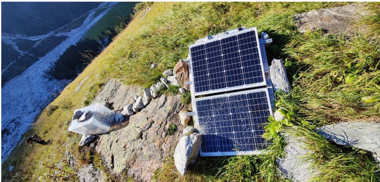
Abbildung 10: Steinschlagschäden am autarken Seismik-Monitoring (27.09.2023).
