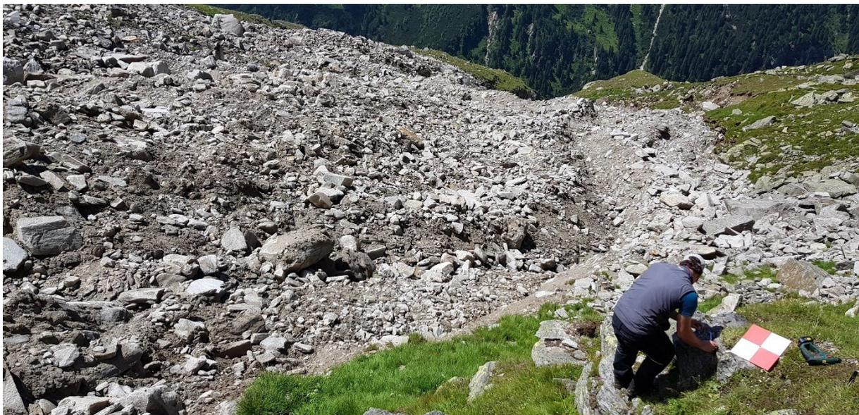
Abbildung 7: Installation von Boden-Kontrollpunkten (12.07.2018).
