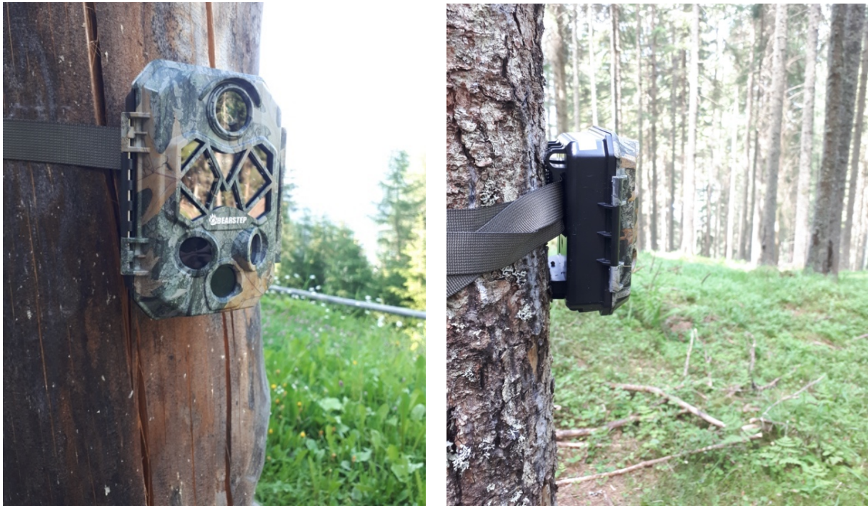
Abb.6 Kamerafallenmodell (Bearstep Wildkamera ULTRA HD Weitwinkel Pro 32), welches für die Erhebungen im Rahmen dieses Projekts verwendet wurde. Infrarot-Sensoren dienen der Detektion von Bewegungen vor der Kamera. Ein Rotlichtblitz ermöglichte während der Nachtstunden hochauflösende Aufnahmen, ohne die Tiere zu blenden. (Foto links: Sophie Nöbauer, Foto rechts: Paul Griesberger)
